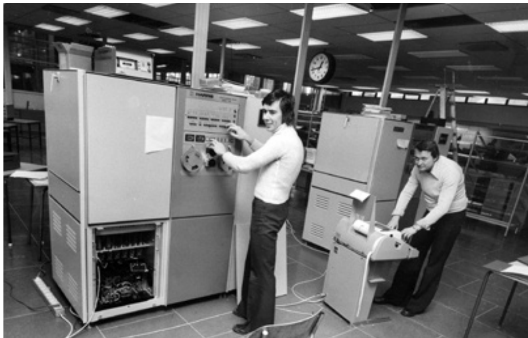
Dagbladet og Arbeiderbladet samarbeidet i 1975 om innkjøp av nytt setteriutstyr. Her kontrollerer Rolf Ødegård fra Grafisk Maskinservice og Tom Knudsen fra Norsk Data at dataanlegg og fotosetter kommuniserer med hverandre. (Foto: Arbark)
