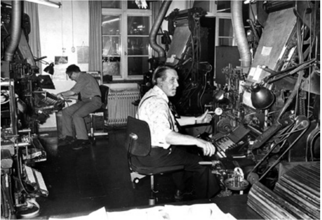
Automatiserte settemaskiner kunne fra 1950-årene styres ved hjelp av hullbånd fra teletypemaskiner. (Foto: Arbark)
