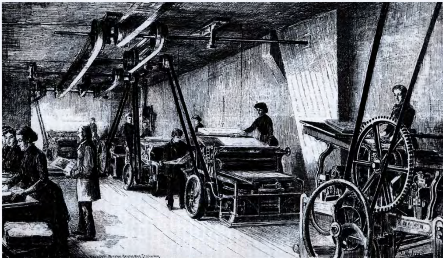
Ikke alle hadde råd til eller behov for rotasjonspresser. De minste avisene klarte seg med sylinderpresser av den typen som vi ser her fra trykkerisalen hos Fabritius Bogtrykkeri i 1885. Enkelte småaviser hadde presser av denne typen helt fram til 1950-60-årene. (Fra Skilling-Magazin 1885)
