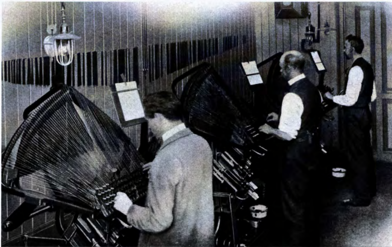
Morgenbladet var tidlig ute med å kjøpe settemaskiner, og ingen kjøpte så mange Typograph-maskiner som Morgenbladet. Her ser vi avisens tre Typograph-maskiner i virksomhet tidlig på 1900-tallet. (Bilde fra: Morgenbladet 90 aar. 1819-1909)
