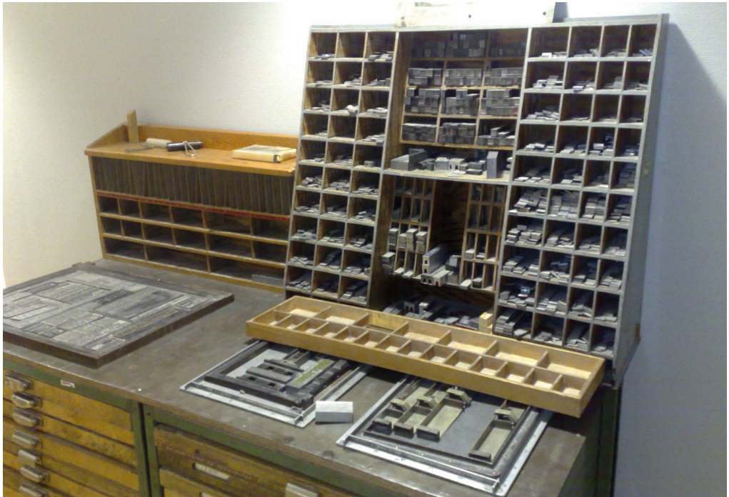
Fra arbeidsverktøy til museumsgjenstand: settekasse for blytyper. Foto: Bengt Engan.
